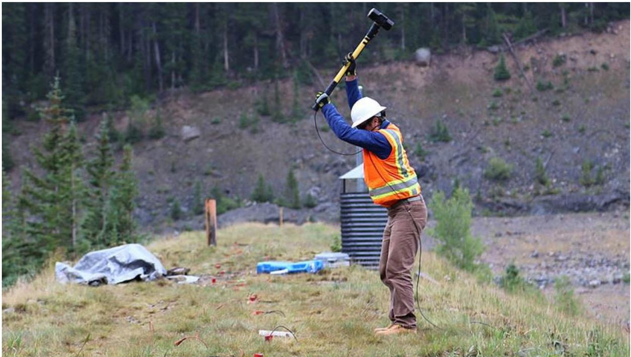
Abbildung einer seismischen Anregung durch ein Fallgewicht (Quelle: hydro Geophysics Service, [www.hgiworld.com](http://www.hgiworld.com))
