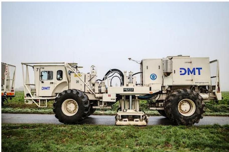
**Abb. 1: Für die 2D-Seismik vorgesehener Vibro-Truck**
