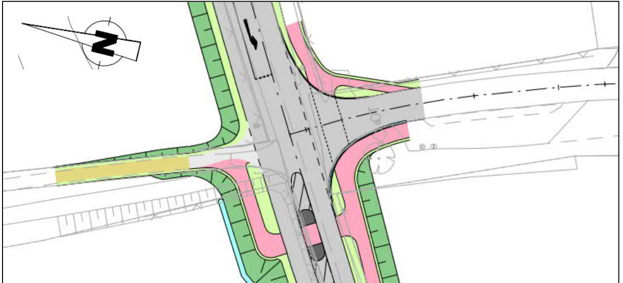
Abbildung 19: GR-Wegführung über die B 472 mittels Querungshilfe
